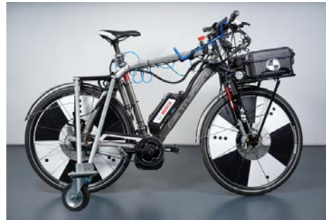
E-Bike-Versuchsträger mit Stützkonstruktion für ABS-Versuche
